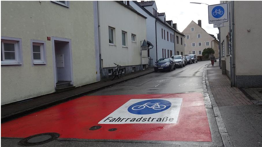
Abbildung 6: Fahrradstraße in Freising mit Roteinfärbung und Fahrradstraßenpiktogramm auf der Fahrbahn
