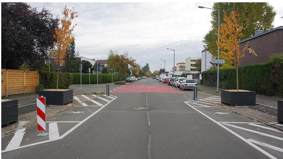
Abbildung 5: Fahrradstraße in Nürnberg mit Roteinfärbung im Knotenpunkt und Einengung der Fahrgasse
